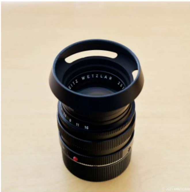
Summilux 50mm f1.4 (2nd ver.) 市販のフィルター径43mmのフード装着
